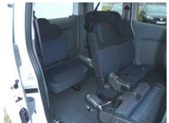
In der zweiten Sitzreihe finden Personen bis mindestens 1,84 m Körpergröße ausreichend Platz vor, in der dritten Sitzreihe wird es dagegen eng - hier wird nur noch Platz für Personen bis 1,77 m Körpergröße angeboten.
