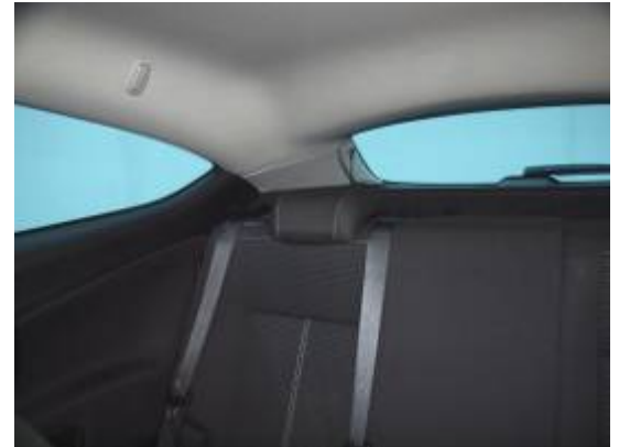
Die besonders breiten Dachsäulen und hohen Fensterlinien schränken die Sicht nach schräg hinten erheblich ein.
