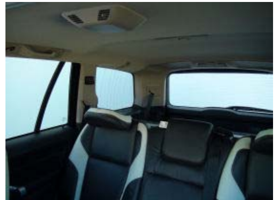
Die Sicht nach schräg hinten wird durch schmale Dachsäulen und versenkbaren Kopfstützen begünstigt.
