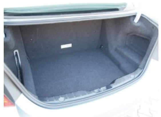
Mit 325 l bietet der ActiveHybrid 5 um 100 l weniger Kofferraumvolumen als seine herkömmlich angetriebenen Brüder.
