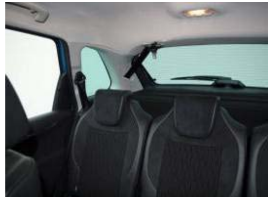
Versenkbare Kopfstützen und nicht zu breite Dachsäulen erleichtern die Sicht nach hinten.
