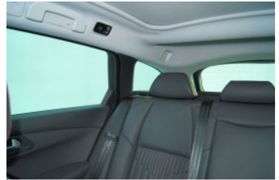
Breite Dachsäulen und nicht versenkbare Kopfstützen verhindern eine gute Sicht nach hinten.
