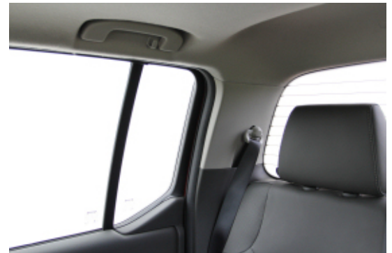
Breite Dachsäulen und nicht versenkbare Kopfstützen erschweren die Sicht nach schräg hinten.
