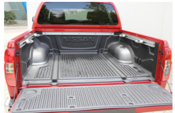
Die Ladefläche ist großzügig und bietet auch zwischen den Radhäusern Platz für eine Euro-Palette. Die hohe Lage der Ladefläche erschwert allerdings die Beladung.
