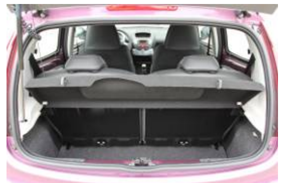
Nur 140 l fasst das Gepäckabteil des 107. Zusätzlich stört eine Stufe im Kofferraumboden, wenn die Lehnen der Rücksitze nach vorn geklappt sind.
