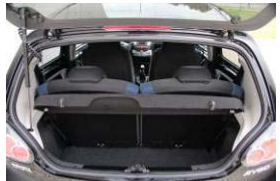
Nur 140 l fasst das Gepäckabteil des Toyota Aygo. Zusätzlich stört eine Stufe im Kofferraumboden, wenn die Lehnen der Rücksitze nach vorn geklappt sind.
