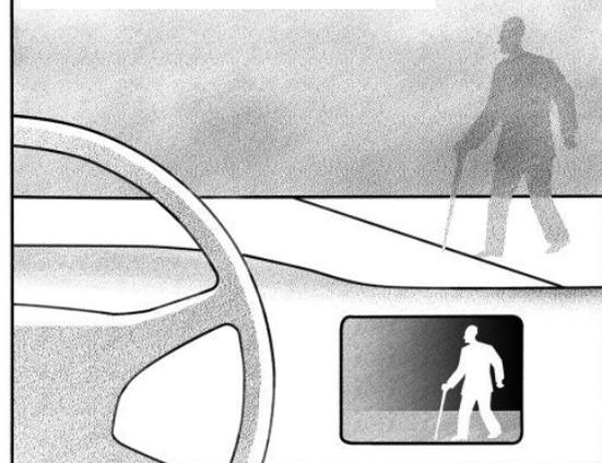
Der Fahrer sieht auf einem Display im Cockpit das elektronisch aufgeteilte Bild einer nach vorn blickenden Kamera.
