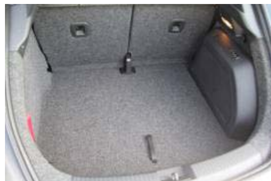
Der Kofferraum mit 270 l Volumen ist in dieser Fahrzeugklasse nur von durchschnittlicher Größe.
