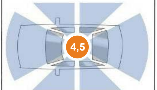
Breite Dachsäulen erschweren die Sicht nach schräg hinten.
