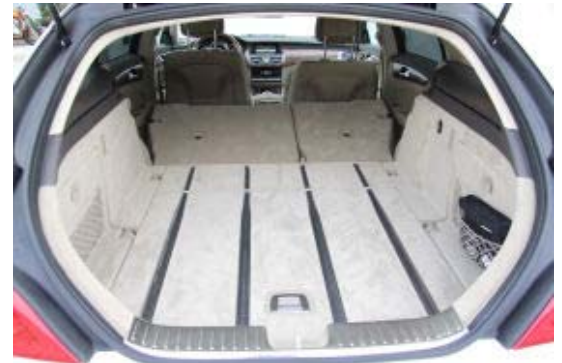
Der Kofferraum mit 380 l Volumen ist gegenüber dem herkömmlichen CLS-Modell (425 l) kleiner ausgefallen.
