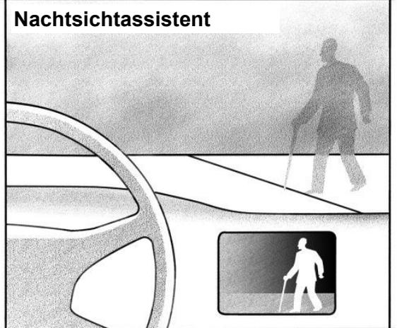
Der Fahrer sieht auf einem Display im Cockpit das elektronisch aufgehellte Bild einer nach vorn blickenden Kamera.
