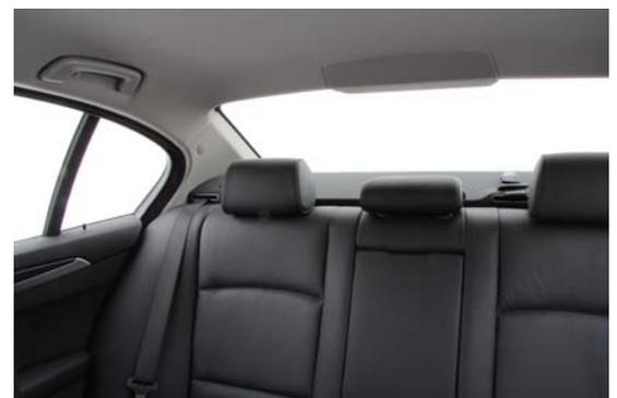
**Breite C-Säulen und nicht versenkbare Kopfstützen schränken die Sicht nach schräg hinten ein.**
