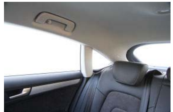
Die breiten Dachsäulen, besonders im Heckbereich, und die hohe Gürtellinie schränken die Sicht im Sportback erheblich ein.
