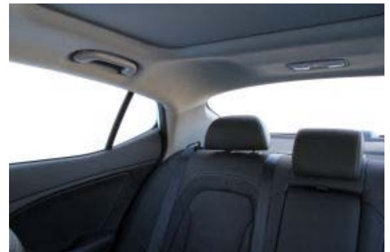
Nicht versenkbaren Kopfstützen sowie breite C-Säulen beeinträchtigen die Sicht nach schräg hinten.
