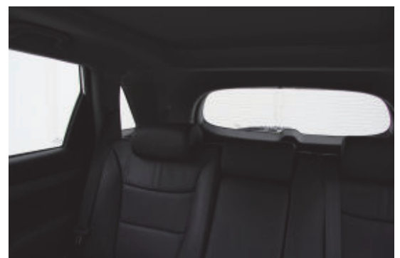
Die zum teil sehr breiten Dachsäulen schränken die Sicht erheblich ein.
