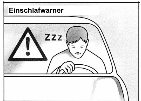
Einschlafwarner Ungewöhnliche Fahrerreaktionen aufgrund von Müdigkeit werden erkannt und führen zu einer Warnung.
