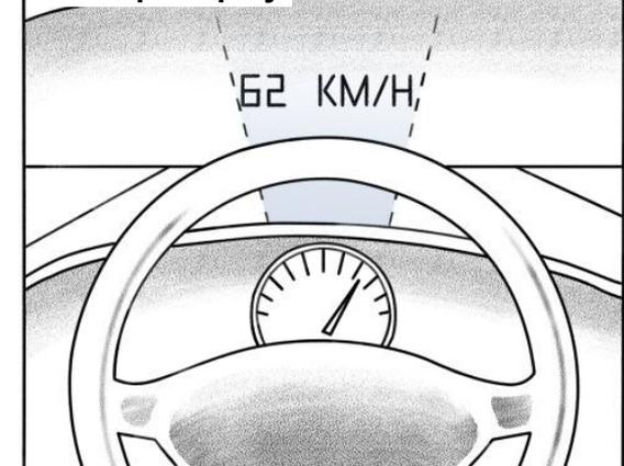
In die Windschutzscheibe werden Geschwindigkeit, Navigationshinweise und andere Informationen eingespiegelt. Dadurch muss der Blick nicht mehr so stark von der Straße nach unten auf den Tacho gesenkt werden, außerdem entfällt die Anpassung der Augen (Akkommodation) auf die unterschiedlichen Entfernungen von Fahrbahn und Kombi-Instrument.
