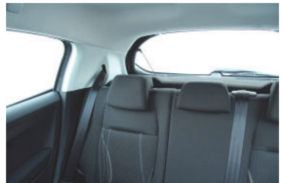
Die breiten Dachsäulen schränken die Sicht stark ein.
