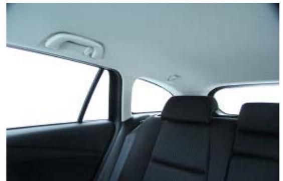
**Trotz versenkbarer Kopfstützen wird die Sicht nach schräg hinten durch breite Dachsäulen erschwert.**
