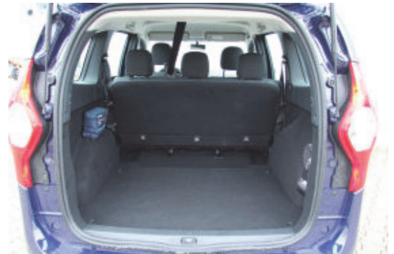
Bei einer Sitzbelegung für fünf Personen fasst der Kofferraum des Lodgy 725 l Gepäck. Ist die dritte Sitzreihe eingebaut, schrumpft der Kofferraum auf das Niveau eines Kleinwagens.
