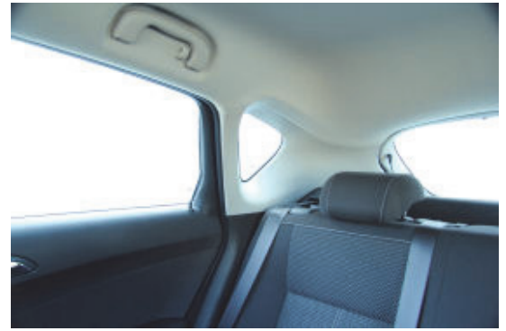
Die besonders breiten Dachsäulen schränken die Sicht nach schräg hinten erheblich ein.
