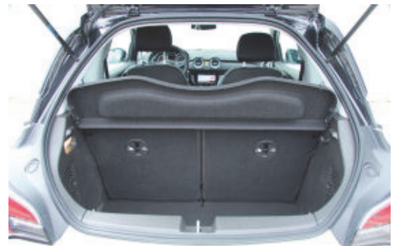
Der Kofferraum mit nur 160 l Volumen fällt in dieser Fahrzeugklasse sehr gering aus.
