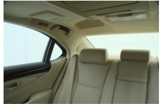
**Die Sicht nach schräg hinten ist aufgrund der breiten Dachsäulen und der nicht voll versenkbare Kopfstützen im Fond erheblich eingeschränkt.**
