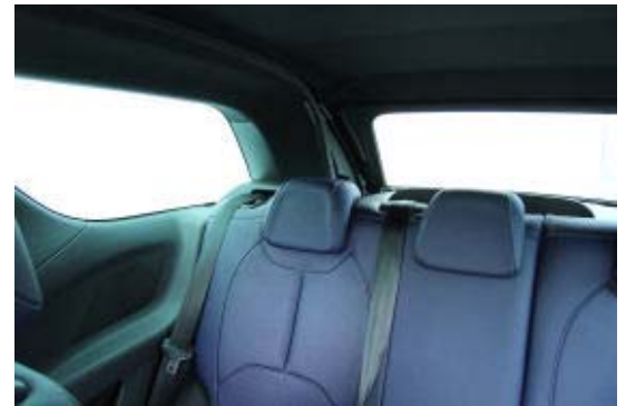
Die breiten Dachsäulen und die hohe Fensterlinie schränken die Sicht nach schräg hinten besonders ein.
