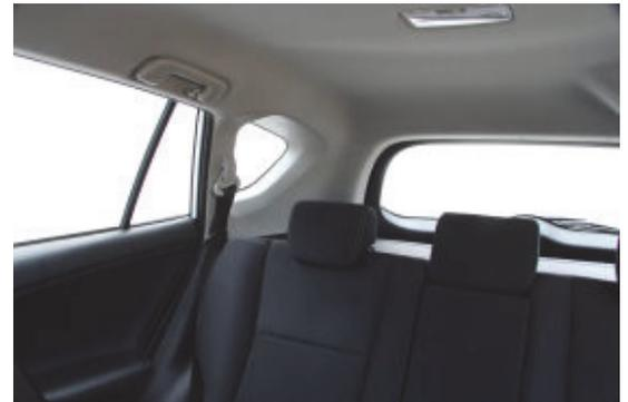
Versenkbare Kopfstützen verbessern die Sicht nach hinten, aber breite Dachsäulen schränken die Sicht nach schräg hinten erheblich ein.
