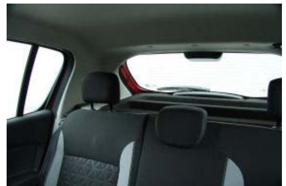
Breite Dachsäulen und die hohe Fensterunterkante verhindern eine gute Sicht nach hinten.
