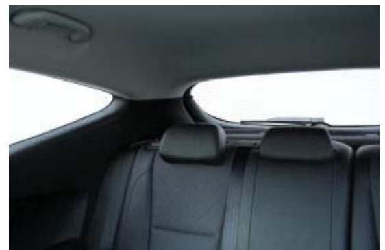
Die versenkbaren Kopfstützen verbessern die Sicht nach hinten, die breiten C-Säulen beeinträchtigen aber den Blick nach schräg hinten sehr.
