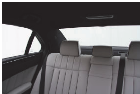
Die Sicht nach hinten wird durch nicht versenkbare Kopfstützen beeinträchtigt.
