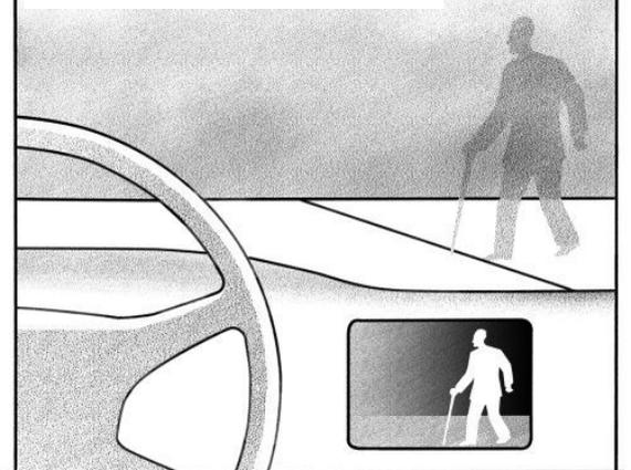
Der Fahrer sieht auf einem Display im Cockpit das elektronisch aufgehellte Bild einer nach vorn blickenden Kamera.
