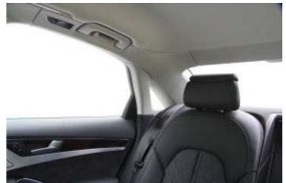
**Breite Dachsäulen und nicht versenkbare Kopfstützen erschweren die Sicht nach schräg hinten erheblich.**
