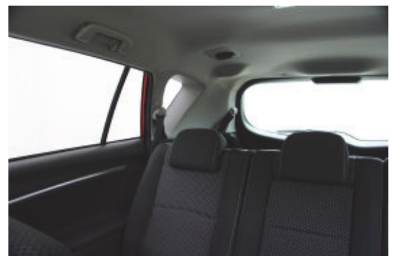
Breite Dachsäulen im Heckbereich beeinträchtigen Sie Sicht nach schräg hinten
