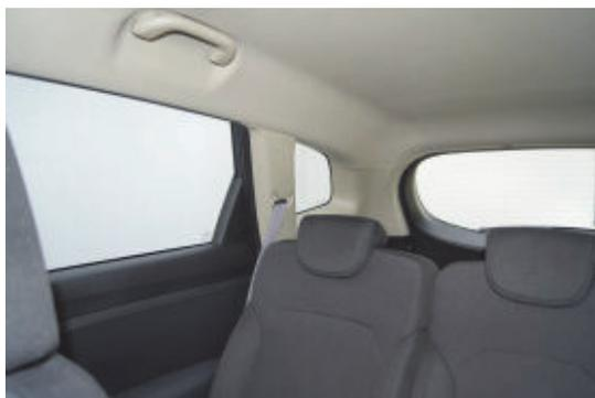
Versenkbare Kopfstützen erleichtern die Sicht nach hinten. Die breiten Dachsäulen erschweren wiederum die Sicht nach schräg hinten.
