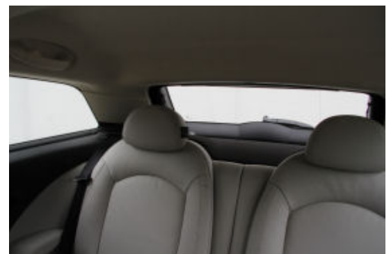
Breite Dachsäulen und nicht versenkbare Kopfstützen erschweren die Sicht nach hinten.
