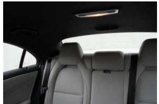
Besonders nach schräg hinten ist die Sicht durch breite Dachsäulen und nicht versenkbare Kopfstützen stark eingeschränkt.
