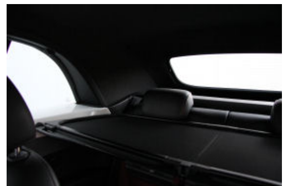
Versenkbare Kopfstützen verbessern die Sicht nach schräg hinten.
