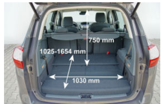
Der Kofferraum des Grand C-Max bietet zwischen 70 (bei aufgestellter 3. Sitzreihe) und üppigen 865 l Volumen zur Verfügung.
