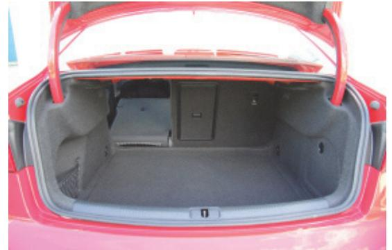
Mit 365 l Volumen fällt der Kofferraum bei der Limousine um 75 l größer aus als beim Schrägheckmodell.
