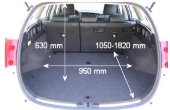
Der Kofferraum ist mit 415 l Volumen für eine Kombilimousine der unteren Mittelklasse nur durchschnittlich groß.
