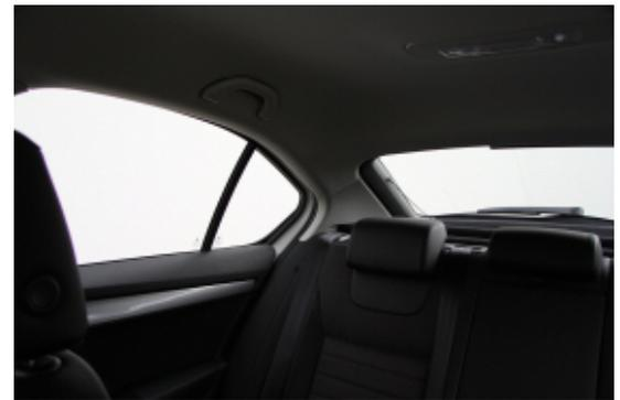
Trotz versenkbaren Kopfstützen wird die Sicht nach schräg hinten durch breite Dachsäulen eingeschränkt.
