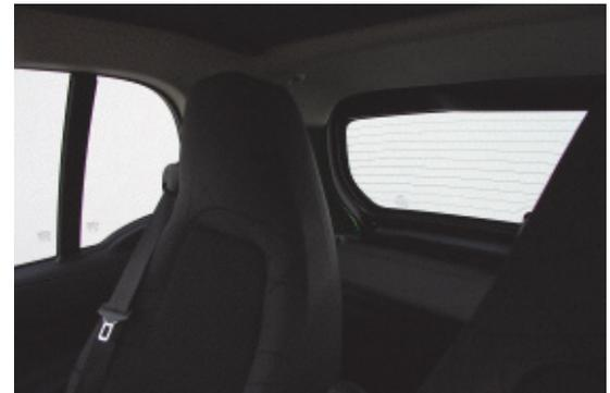
Breite Dachsäulen und die schmale Heckscheibe beeinträchtigen die Sicht nach schräg hinten.
