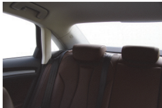
Aufgrund der relativ breiten Dachsäulen ist die Sicht nach schräg hinten eingeschränkt.
