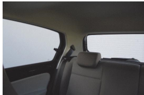
Die Sicht nach hinten ist aufgrund der teilversenkbaren Kopfstützen und der nicht allzu breiten Dachsäulen relativ gut.
