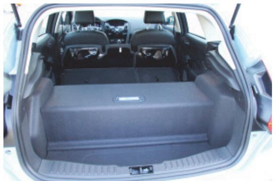
Der Kofferraum fällt mit 220 l Volumen nicht nur deutlich kleiner aus als beim herkömmlich angetriebenen Focus, er ist durch Stufe auch deutlich schlechter nutzbar.
