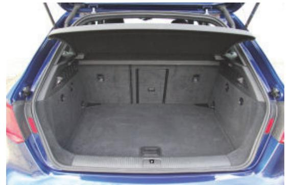
**Der Gastank unter dem Kofferraumboden verringert das Kofferraumvolumen (250 l) gegenüber Modelle mit konventionellem Antrieb (290 l).**
