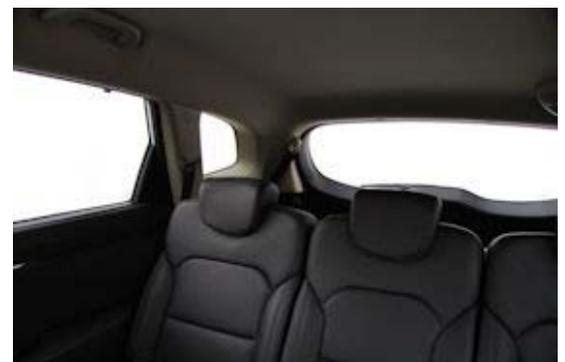
Versenkbare Kopfstützen erleichtern die Sicht nach hinten. Die breiten Dachsäulen erschweren wiederum die Sicht nach schräg hinten.
