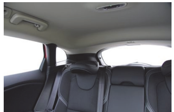
Trotz klappbaren Kopfstützen wird die Sicht nach schräg hinten durch die breiten Dachsäulen erheblich eingeschränkt.
