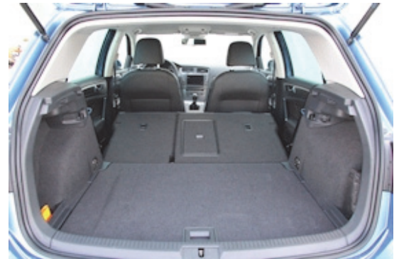
Mit 245 l Volumen ist der Kofferraum des Golf TGI um 60 l kleiner als beim Golf ohne Gastank.
