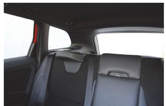
Elektrisch umklappbare Kopfstützen erleichtern die Sicht nach hinten.
