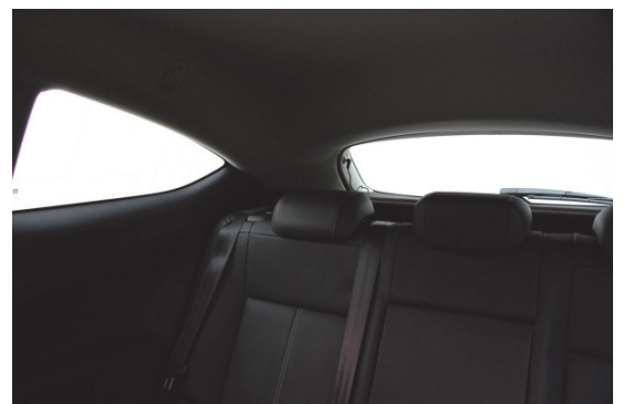
Die besonders breiten Dachsäulen und hohen Fensterlinien schränken die Sicht nach schräg hinten erheblich ein.
